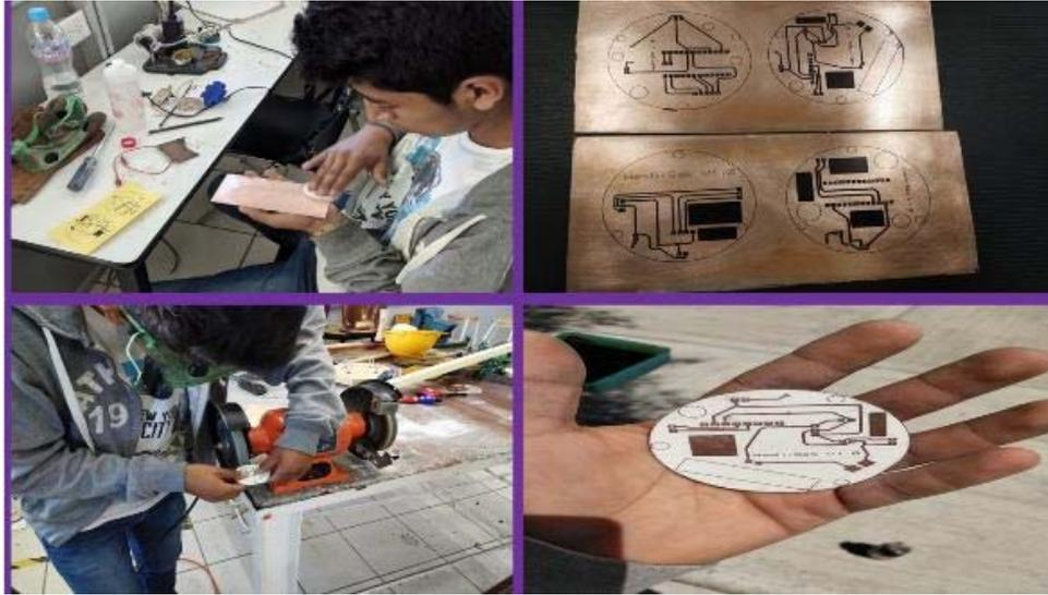
*Figura 5.* Manufactura de las etapas electrónicas.
