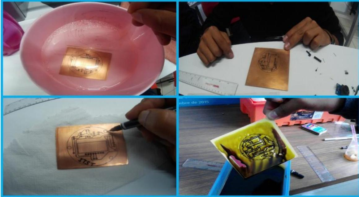
**Figura 6. Impresión a placa fenólica**
