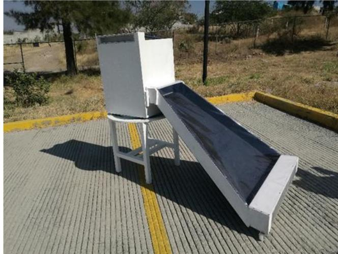
*Figura 1.* Prototipo de deshidratador solar automatizado. Elaboración Propia
