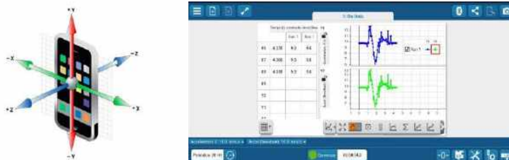
Figura 1. Izquierda: esquema que representa la distribución espacial de los ejes coordenados x , y & z en el acelerómetro de los celulares. Derecha: captura de la pantalla de visualización de las mediciones de la aceleración en la aplicación SPARKvue de Pasco
