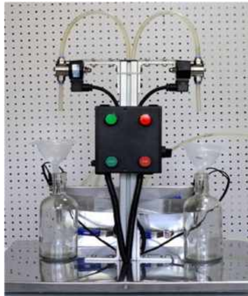
Figura 3. Cabezal dosificador de una máquina automática para embotellar bebidas alcohólicas
