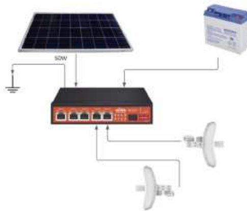
Figura 4. Funcionamiento del switch PoE WI-PS306GF-UPS
